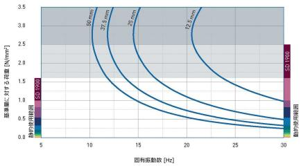
固い路盤上において固定質量とPURASYS vibrafoamのSD1900による弾性支承とによって構成された一自由度系の固有振動数。
