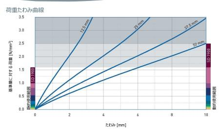
載荷3回目の記録。毎秒たわみ率を厚さの1%として測定した室温において鋼板間で試験実施。 フォームファクタ q = 1.25
