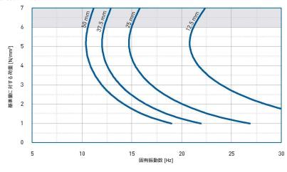
固い路盤上において固定質量とPURASYS vibradynのHL6000による弾性支承とによって構成 された一自由度系の固有振動数。
