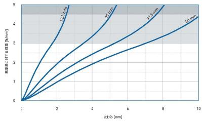
載荷3回目の記録。v=0.2N/mm²/秒で測定した、 室温で粒度K120のエメリークロスで処理した鋼板間 で試験実施。
