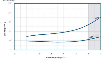
動的試験:振動範囲が、10 Hzで±0.11 mmの正 弦波加振
