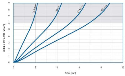
載荷3回目の記録。v=0.4N/mm²/秒で測定した、 室温で粒度K120のエメリークロスで処理した鋼板間 で試験実施。
