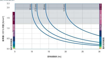
固い路盤上において固定質量とPURASYS vibrafoamのSD1300による弾性支承とによって構成された一自由度系の固有振動数。
