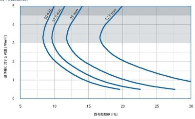
固い路盤上において固定質量とPURASYS vibradynの HL3000による弾性支承とによって構成された一自由度系の固有振動数。
