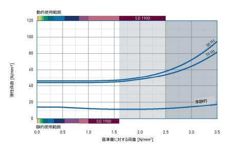
動的試験:振動範囲が10 Hzで±0.22 mm、 30 Hzで±0.08 mmの正弦波加振
