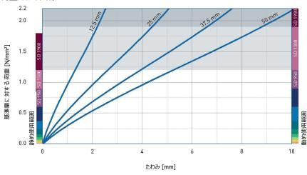
載荷3回目の記録。毎秒たわみ率を厚さの1%として測定した室温において鋼板間で試験実施。 フォームファクタ q=2
